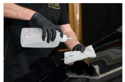
Kontrollieren Sie die Fahrzeugoberflächen und Kanten auf etwaige Oberflächen-Verunreinigungen und Rückstände. Reinigen Sie alle zu beklebenden Flächen mit Silikonentferner oder Isopropanol-Wasser-Gemisch 50/50 nach. Stellen Sie sicher, dass eventuell noch vorhandene Reste von Reinigungsmitteln gründlich und vollständig entfernt werden.
