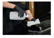
Kontrollieren Sie die Fahrzeugoberflächen und Kanten auf etwaige Oberflächen-Verunreinigungen und Rückstände. Reinigen Sie alle zu beklebenden Flächen mit Isopropanol-Wasser-Gemisch 50/50 nach. Stellen Sie sicher, dass eventuell noch vorhandene Reste von Reinigungsmitteln gründlich und vollständig entfernt werden.
